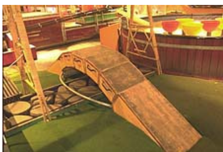
Figur 2.3. Buebro i Experimentariums udstillingshal. Broen er en bærende konstruktion helt uden brug af bindemateriale mellem klodserne. Klodserne er lavet af træ, så de kan håndteres af børnene. I den virkelige verden er de lavet af sten, da de skal kunne modstå et stort tryk.
